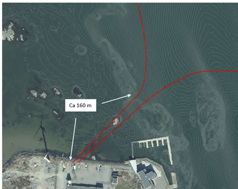
Figur 37. Föreslagen styrd borring ut från Pinans ARV. Dragning på land vid Pinan anpassas till framtida utformning av reningsverket.
