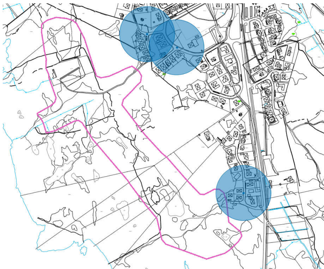
Figur 10 Befintliga brandposter med 75 meter radie
