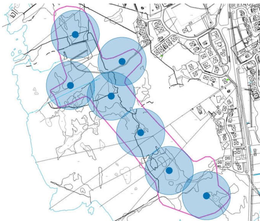
Figur 13 Illustration av exempel på brandpostplaceringar för att efterleva ca 150 m mellan varje brandpost
