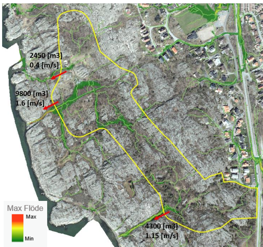
Figur 16 Avrinningsvägar och maxflöde för planområde B3 vid ett klimatanpassat 100-årsregn för befintlig situation.
