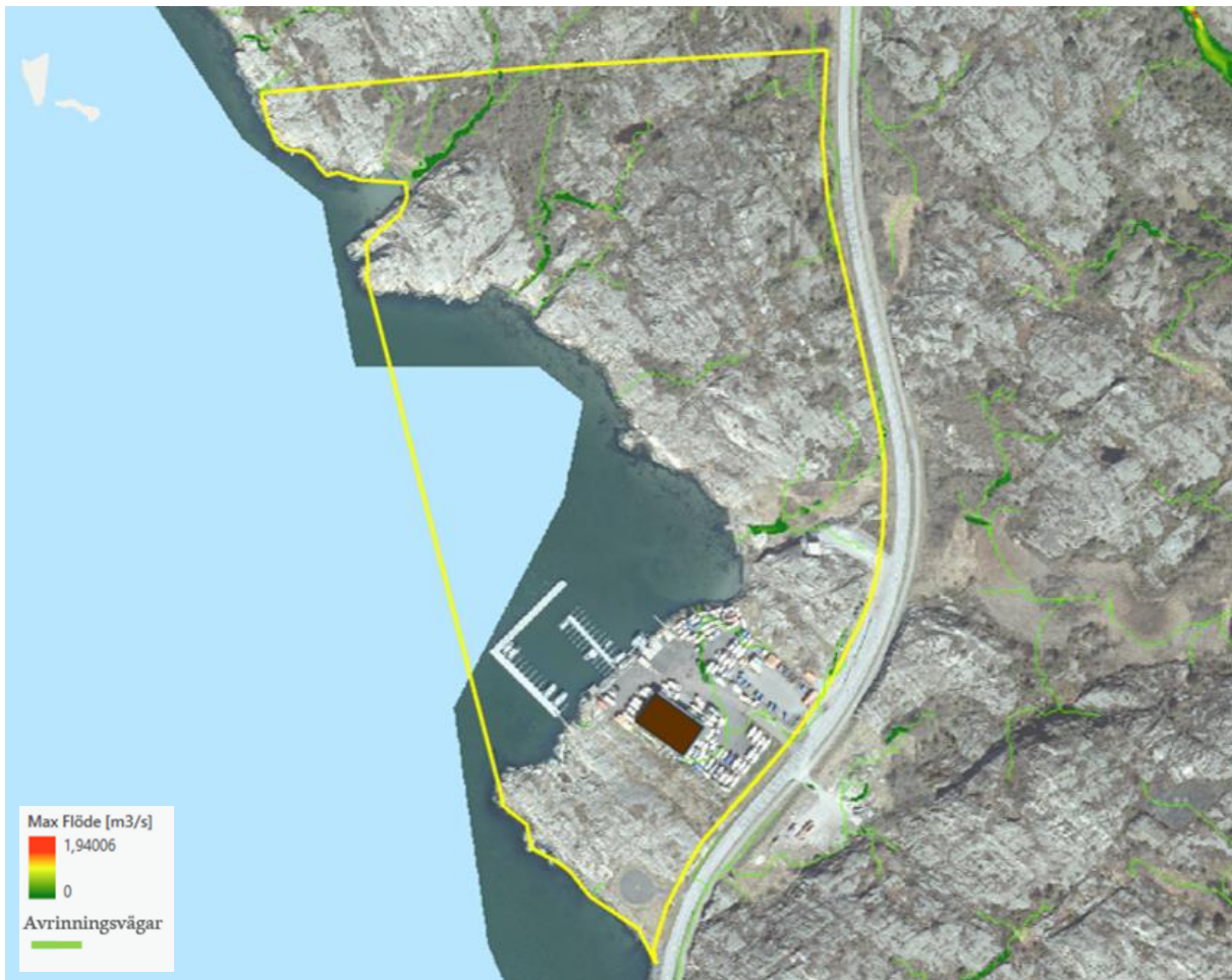
Figur 37 Avrinningsvägar och maxflöde för planområde U3 vid ett klimatanpassat 100-årsregn för befintlig situation.
