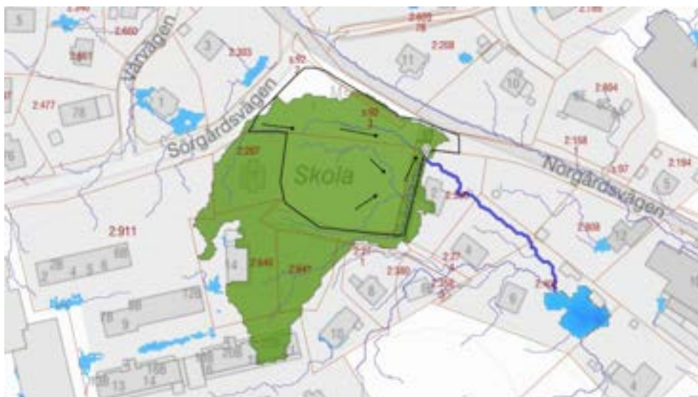
Figur 7. Ytligt avrinningsområde till lågpunkt. Bilden redovisar även rinnvägar och vattensamling i lågpunkter vid 20 mm regn i blått och flödesriktning med svarta pilar. Grönt fält visar avrinningsområdet. Svart markerat område visar plangräns. Bild från Scalgo Live.
