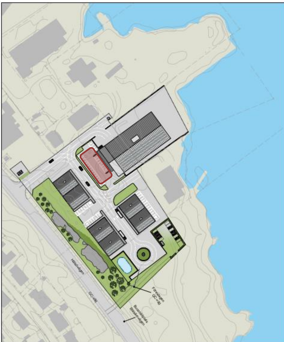
Figur 7. Illustrationskarta över planområdet. Inom rödmarkerad yta i norr anläggs krossmagasin för fördröjning av dagvatten och i söder anläggs dagvattendamm.
